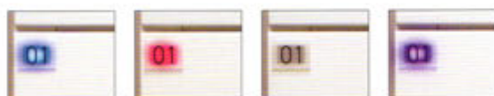
「青点灯」：貸出可 「青点滅」：扉開錠 「赤点灯」：貸出中 「赤点滅」：エラー 「消灯」：利用停止、またはデリバリー中 「紫点灯」：充電検知エラー
